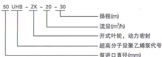
UHB-ZK 砂浆泵性能参数表
